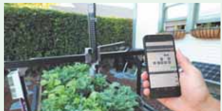
Роботизированная система, предназначенная для выращивания овощей. Управление данной системой осуществляется через Wi-Fi. Есть возможность удаленного контроля через Интернет.
